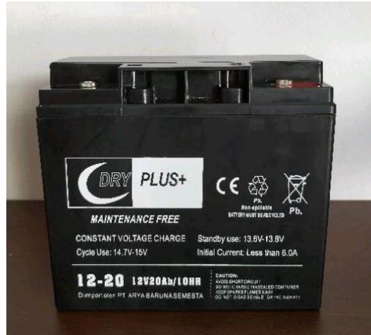
Gambar II. 7 Baterai Aki 12 V 20Ah (Sumber: Dokumentasi Pribadi)
