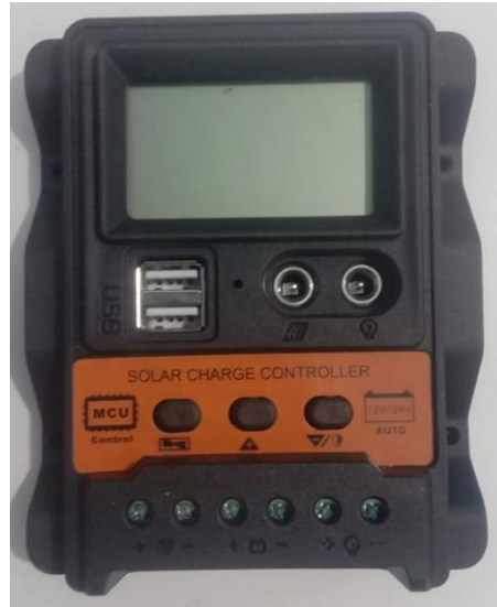
Gambar II. 6 Solar Charge Controller (SCC) (Sumber: Dokumentasi Pribadi)
