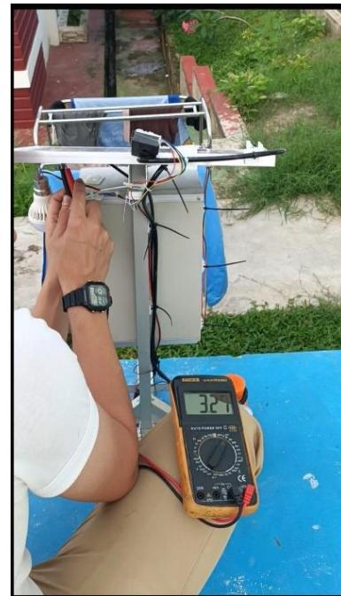
Pengujian siang hari pada pukul 17.00 WIB didapatkan tegangan sebesar 3,27 V sebelum dilakukannya pembersihan pada panel surya.
