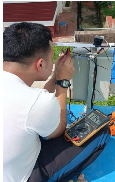
Pengujian siang hari pada pukul 13.00 WIB didapatkan tegangan sebesar 17,47 V setelah dilakukannya pembersihan pada panel surya.
