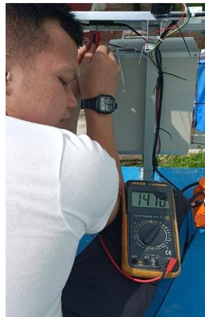
Pengujian siang hari pada pukul 13.00 WIB didapatkan tegangan sebesar 14,10 V sebelum dilakukannya pembersihan pada panel surya
