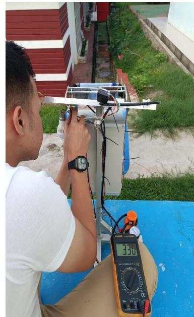
Pengujian sore hari pada pukul 17.00 WIB didapatkan tegangan sebesar 3,30 V setelah dilakukannya pembersihan pada panel surya.
