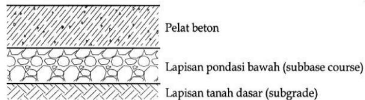
Gambar II. 3 Struktur Perkerasan Kaku
