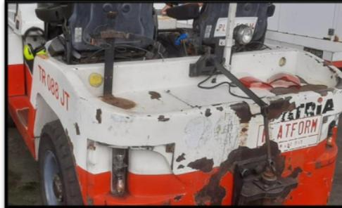
Gambar IV. 7 BTT Dengan Kabel Tidak Tertutup
