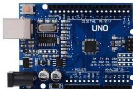
Gambar II. 5 Arduino Uno ATmega328P
