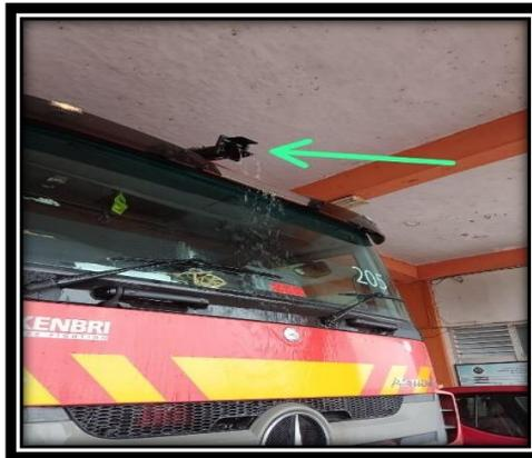
Gambar 1. 1 Dampak Kerusakan *Solenoid Valve*
