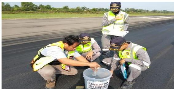
Gambar II. 2 Kegiatan Pengukuran Kekesatan Landas Pacu menggunakan *Sand Patch*
