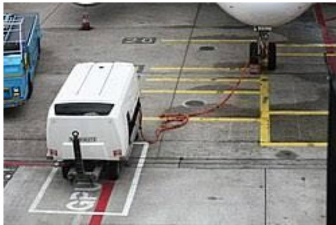
Gambar II. 3 *Ground Power Unit* (GPU)
