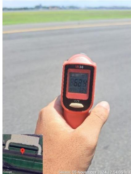
Gambar II. 1 Pengecekan Temperatur Permukaan Landasan
