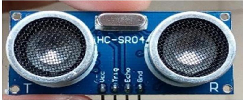
Gambar II. 4 Sensor *Ultrasonic*
