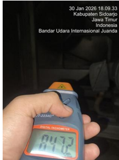
Gambar II. 3 Pengukuran Nilai RPM Menggunakan Tachometer
