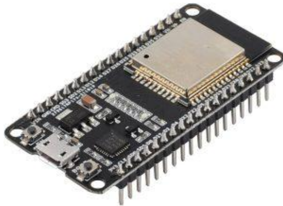
Gambar II. 3 Mikrokontroler ESP32 (Sumber: pi.ezlo.com )
