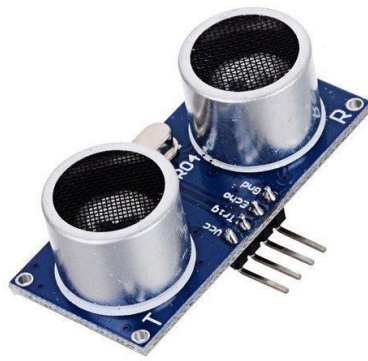
Gambar II. 4 Sensor Ultrasonik HC-SR04 (Sumber: arduinoindonesia.id )
