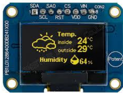
Gambar II. 10 Layar Display OLED (Sumber : Arduino Indonesia)
