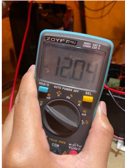
B. 7 Pengambilan Data Tegangan menggunakan Multimeter Digital (Sumber: Dokumentasi Pribadi)
