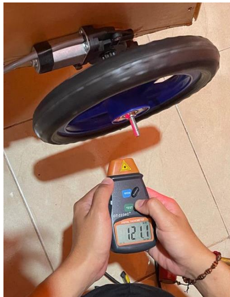
B. 8 Pengambilan Data Kecepatan Motor DC menggunakan Tachometer (Sumber: Dokumentasi Pribadi)
