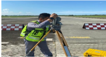
Gambar IV. 2 Pengukuran Benchmark dan Strip Intersection Taxiway (Sumber : Penulis, 2024)
