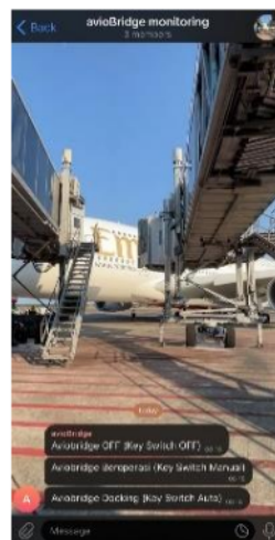
Gambar IV. 48 Telegram Aviobridge Docking Key Switch docking Sumber:penulis
