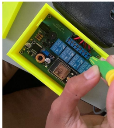
Gambar IV. 31. Integrasi Pcb dan relay Aviobridge Sumber:penulis
