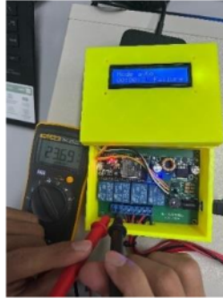
Gambar IV. 49 Uji tegangan Aviobridge failure (relay 1) Sumber:penulis
