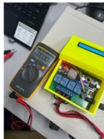
Gambar IV. 34 Uji tegangan relay Aviobridge mati Sumber:penulis
