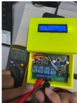
Gambar IV. 45 Uji tegangan key switch Auto (relay 3) Sumber:penulis
