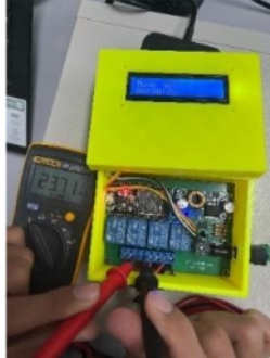
Gambar IV. 44 Uji tegangan key switch Auto (relay 2) Sumber:penulis
