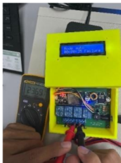
Gambar IV. 51 Uji tegangan Aviobridge failure (relay 3) Sumber:penulis
