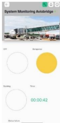
Gambar IV. 42 Blynk AvioBridge Beroperasi Key Switch Manual Sumber:penulis
