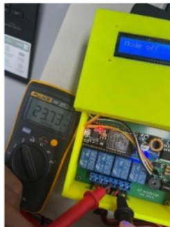
Gambar IV. 37 Uji tegangan key switch OFF ( relay 3) Sumber:penulis
