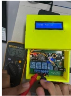
Gambar IV. 40 Uji tegangan key switch Manual (relay 2) Sumber:penulis
