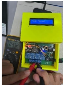
Gambar IV. 41 Uji tegangan key switch Manual (relay 3) Sumber:penulis
