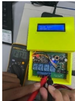
Gambar IV. 46 Uji tegangan key switch Auto (relay 4) Sumber:penulis
