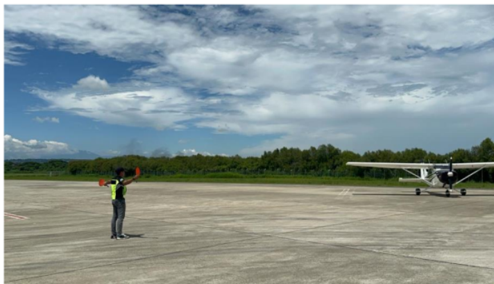
Pemarkiran pesawat dengan posisi paralel tanpa marka taporary
