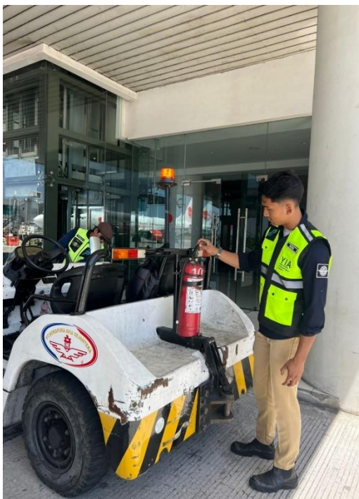
Pengecekan APAR pada kendaraan GSE
