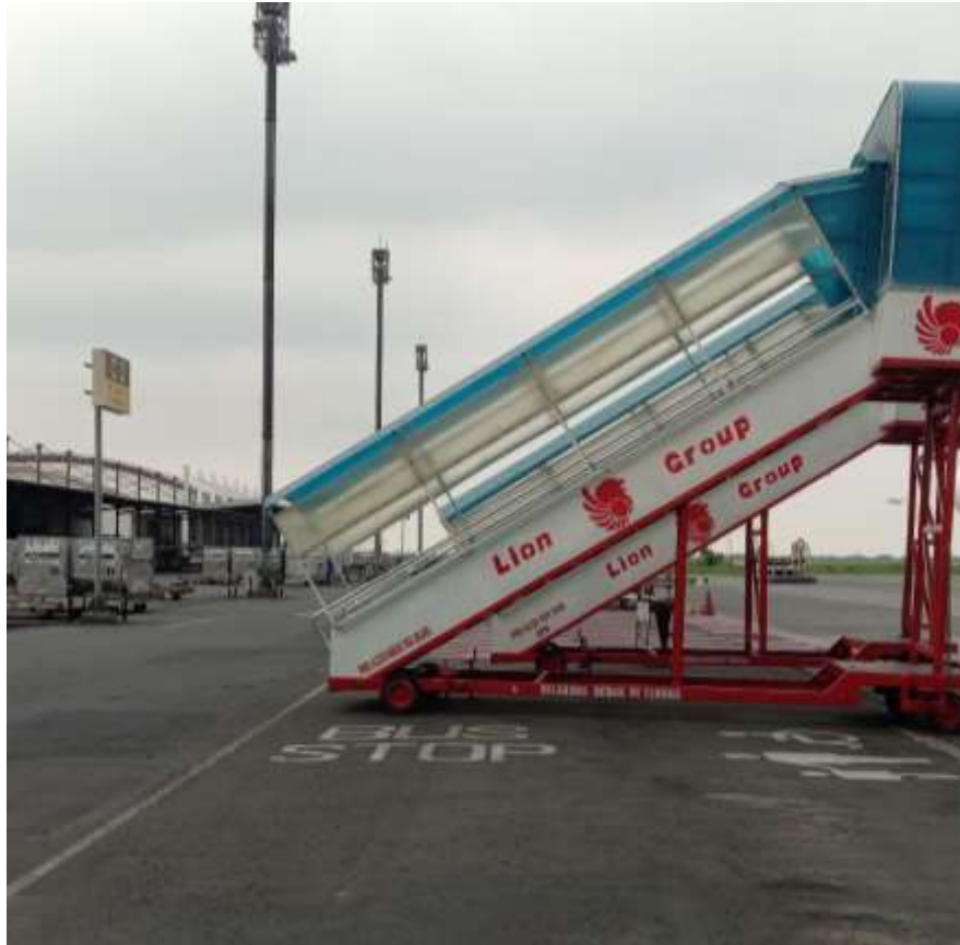
Lampiran A5 Penempatan Peralatan GSE yang tidak sesuai prosedur
