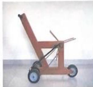
Alat Penggulung Selang (APSEL) Semi Mekanik adalah alat bantu inovatif yang dirancang untuk mempermudah proses penggulungan selang pemadam kebakaran. Alat ini menggunakan sistem mekanik sederhana yang digerakkan secara manual oleh operator untuk menggulung selang secara cepat, rapi, dan efisien.
