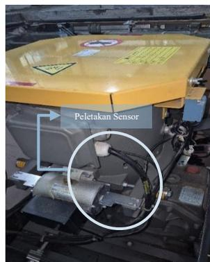
**Gambar II.18** Penempatan Sensor Suhu
