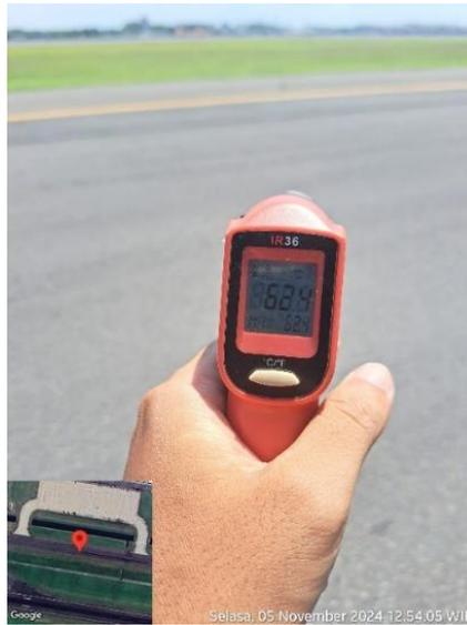
Gambar II. 1 Pengecekan Temperatur Permukaan Landasan
