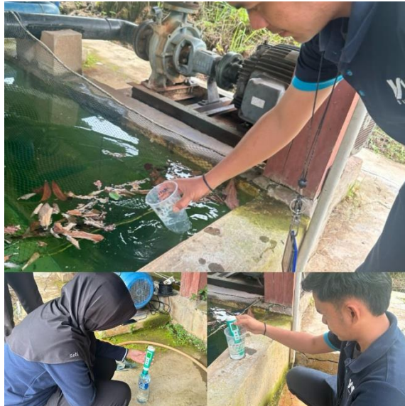
Gambar 1. 1 Pengecekan pH dan TDS di Lokasi Bak Reservoir (Sumber : Dokumentasi Penulis)
