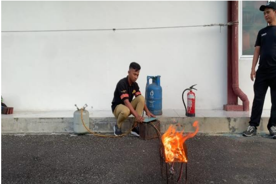
Lampiran 2. Percobaan dan Perancangan Prototype Pressure-fed Fuel Fire di Unit PKP-PK Bandar Udara Internasional Kualanamu.
